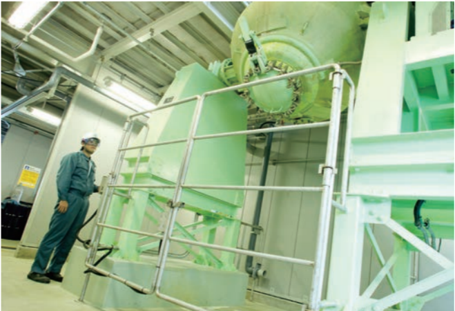
回転乾燥機／Revolving Dryer Machine 内側がガラスライニングで、外側に温水や蒸気を流すジャケットがあり、粉体製品の乾燥に使用します。 With an inner glass lining and an exterior jacket to wash away warm water and steam, this machine is used to dry powder products.
