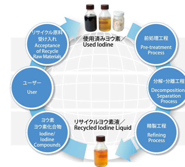
使用済みヨウ素リサイクル工程 / The Process for Recycling Used Iodine
